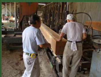
大工と最終打合せして実加工。9寸に挽き直し、あとは鉋をかけて8寸8分の大黒柱へと変身する。
