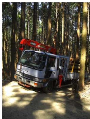
開設したばかりの作業道に4トトラックで間伐材の搬出作業が進む！
